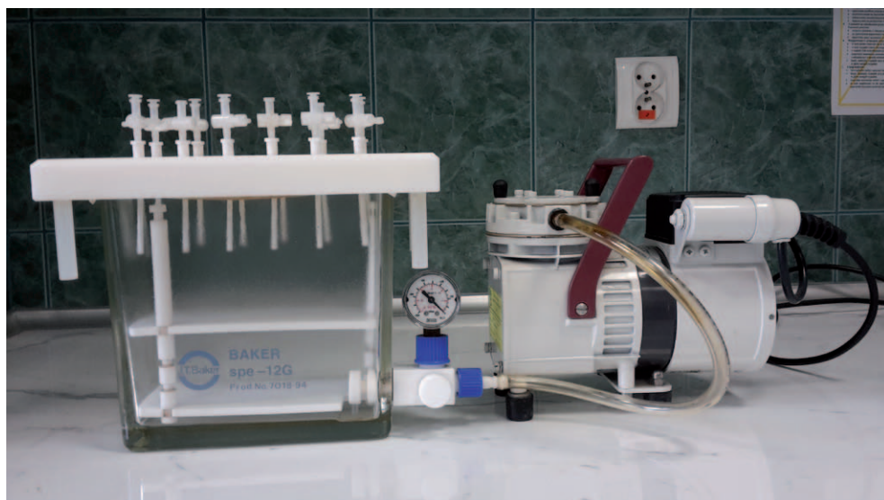
Fot. 3.1. System próżniowy BAKER SPE do przygotowania próbek analitów techniką ekstrakcji na złożu sorpcyjnym SPE
