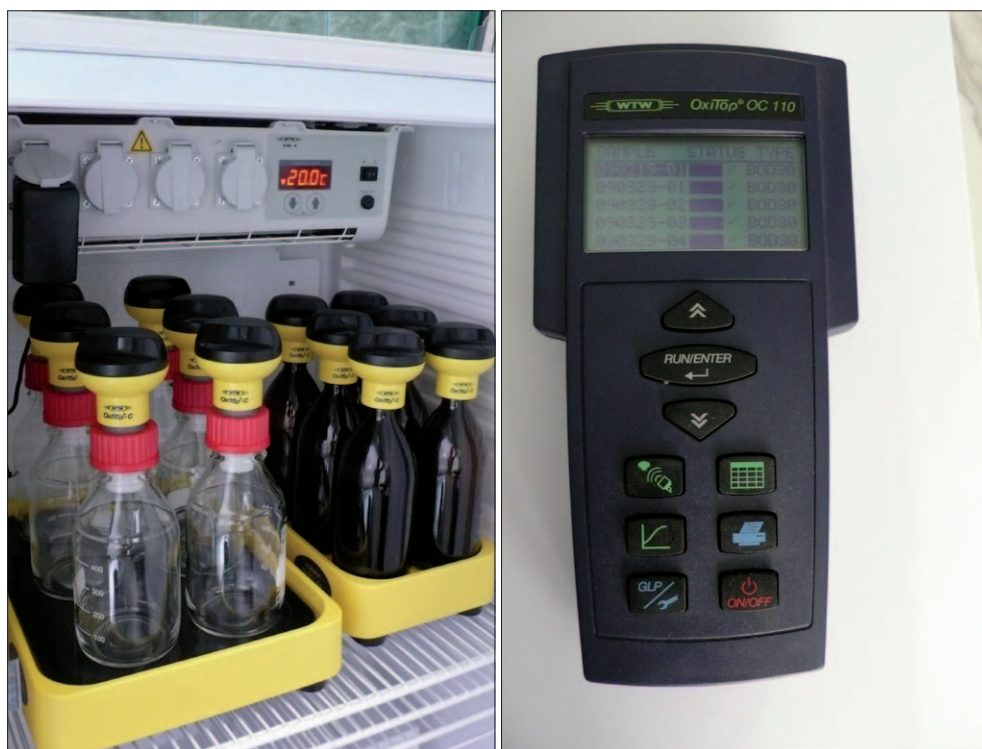
Fot. 3.6. Zestaw OxiTop z podstawą mieszającą i inkubator OxiTop
