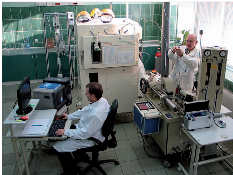
Rys. 5.10. Stanowisko badawcze do modelowania procesów wypierania gazu rozpuszczonego w solankach [78]
