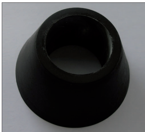
Fot. 6.6. Gumowa tuleja uszczelniająca próbkę
