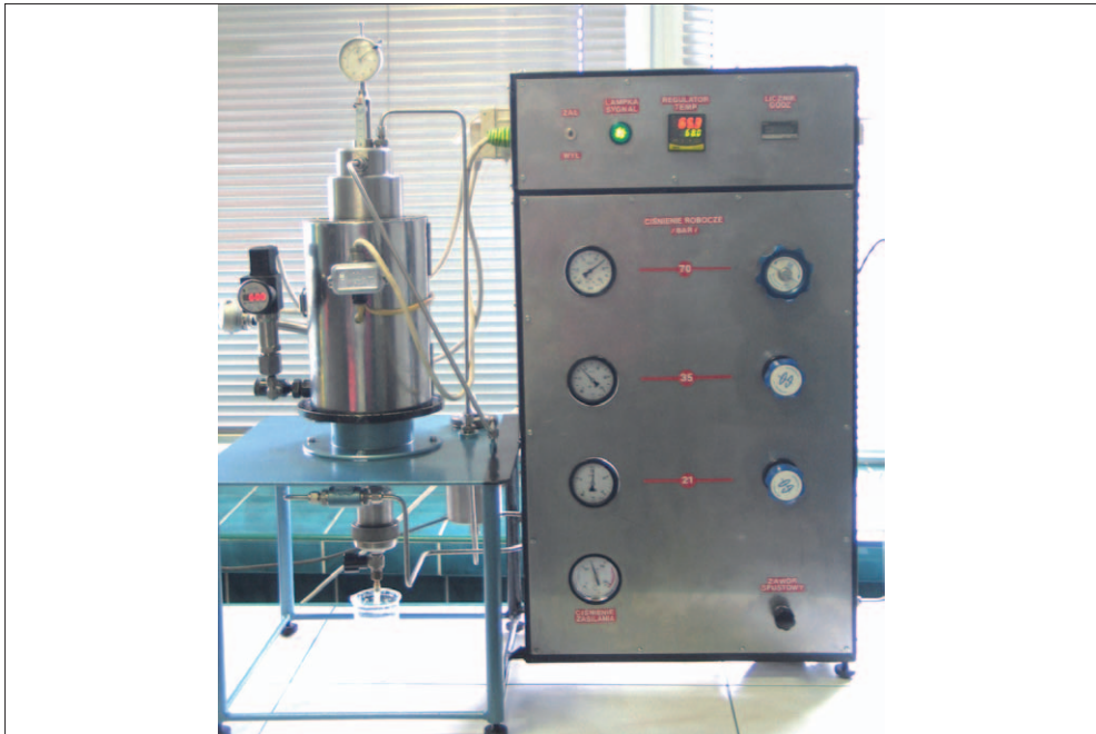
Rys. 6.8. Aparat do badania migracji gazu przez wiązcy zaczyn cementowy w warunkach otworopodobnych
