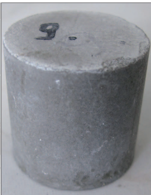
Fot. 6.5. Próbką stwardniałego zaczynu cementowego do badania przepuszczalności gazu
