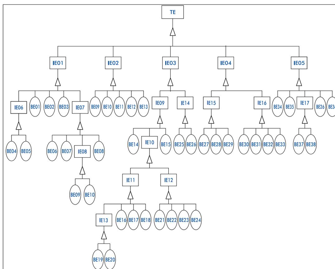
**Figure 2.** The fault tree of the dispenser gas leakage**Rysunek 2.** Drzewo błędów dla wycieku gazu z dystrybutora
