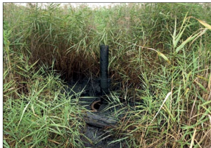
Rysunek 22. Łężyny, Polska. Wypływ ropy ze starego odwiertu Figure 22. Łężyny, Poland. Oil seep from an old well
