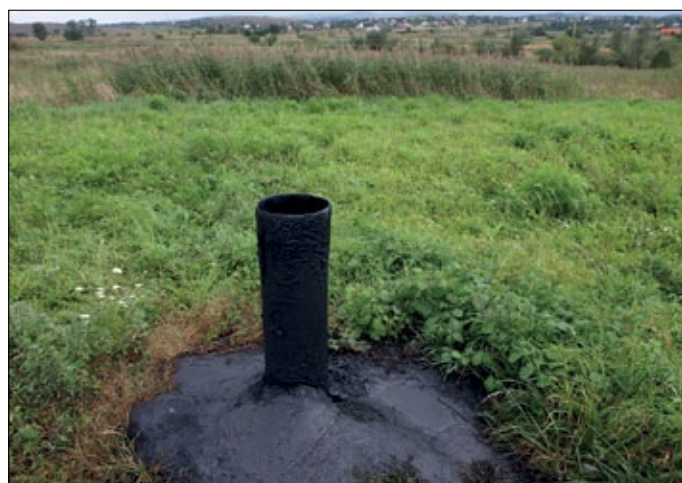
Rysunek 23. Łężyny, Polska. Stary odwiert naftowy Figure 23. Łężyny, Poland. An old oil well
