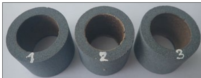
Rysunek 10. Rdzenie ceramiczne po badaniu filtracji na aparacie Grace M2200 HPHT w temperaturze 60°C: 1 – płuczka z dodatkiem 0,7% polimeru PS1, 2 – płuczka z dodatkiem 0,7% polimeru PS6, 3 – płuczka z dodatkiem 0,7% polimeru PS7
