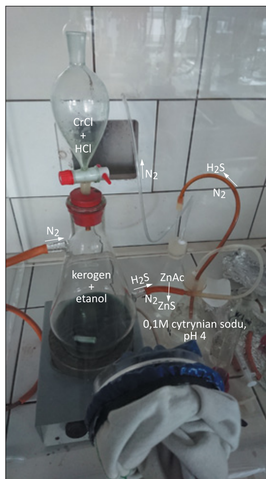
Rysunek 2. Zestaw do usuwania pirytu umieszczony w komorze rękawicowej
