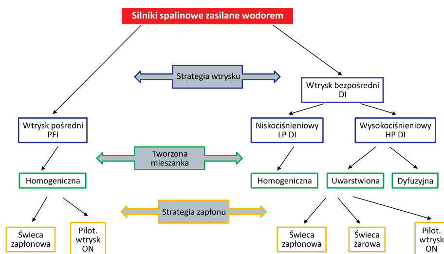
Rys. 1. Różne kombinacje strategii wtrysku i tworzenia mieszanki oraz zapłonu w silnikach spalinowych zasilanych wodorem
