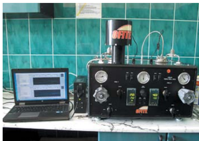
Rys. 1. Aparat SGSM do pomiaru statycznej wytrzymałości strukturalnej
