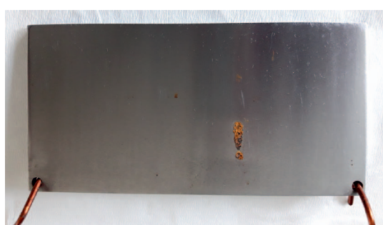
Rys. 9. Płytkę stalową pokrytą mieszanką olejową nr 2
