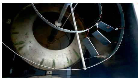
Rys. 2. Wnętrze komory wilgotnościowej z umieszczonymi płytkami
