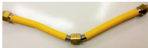
Rys. 5. Próbkę z uszczelnieniem miękkim po badaniu odporności na uderzenie (fot. T. Minor)
