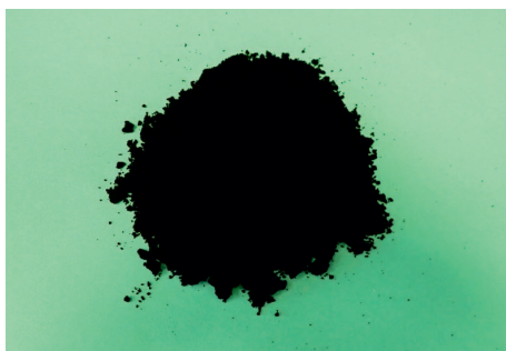
Rys. 1. Wielościenne nanorurki węglowe o średnicy zewnętrznej 10–20 nm i długości 10–30 μm (w postaci proszku) używane w badaniach laboratoryjnych
