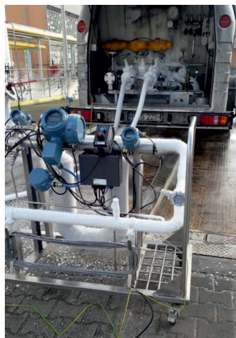
Rys. 4. Przykład testu porównawczego zestawu typu SMOK z precyzyjną wagą pomostową w PGNiG SA w Odolanowie
