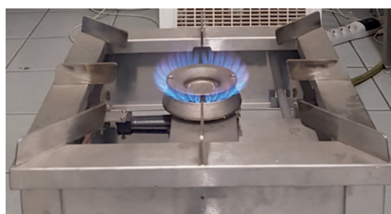
Rys. 3. Widok płomienia mieszaniny gazu ziemnego z 15-procentowym dodatkiem wodoru
