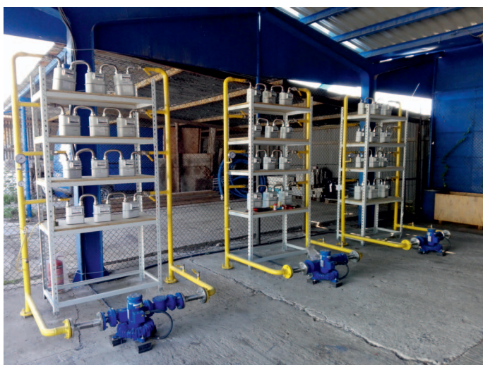
Rys. 4. Widok instalacji badawczej do badania trwałości gazomierzy z użyciem mieszaniny gazu ziemnego z wodorem
