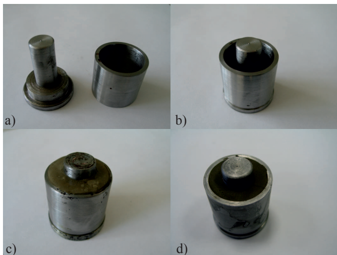
Rys. 2. Próbkę do oznaczania przyczepności stwardniałego zaczynu cementowego na kontakcie z rurą okładzinową; a) próbka zdemontowana, b) próbka gotowa do użycia, c) próbka z zaczynem cementowym, d) próbka gotowa do wykonania pomiaru (ze stwardniałym zaczynem cementowym)
