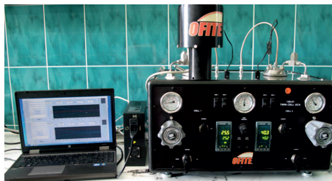
Fot. 1. Ultradźwiękowy analizator cementu z modułem SGSM
