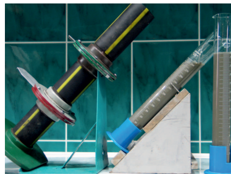
Fot. 2. Stanowisko do oznaczania stabilności sedymentacyjnej zaczynu cementowego i odstoju wody (po lewej stronie kolumna sedymentacyjna, po prawej stronie cylindry do pomiaru odstoju wody)
