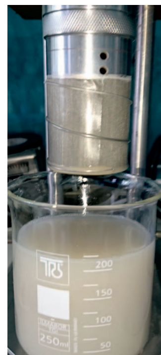
Fot. 7. Usunięcie osadu za pomocą cieczy przemysłowej na bazie środka RR21, stężenie 1,0%. Skuteczność usunięcia osadu równa 75,84%
