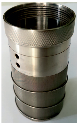
Fot. 3. Widok rotora zmodyfikowanego przy użyciu siatki stalowej
