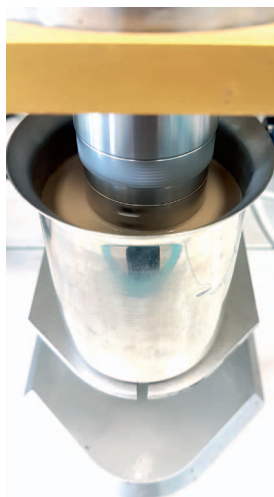
Fot. 2. Rotor zanurzony w płuczce (wytwarzanie osadu płuczkowego)
