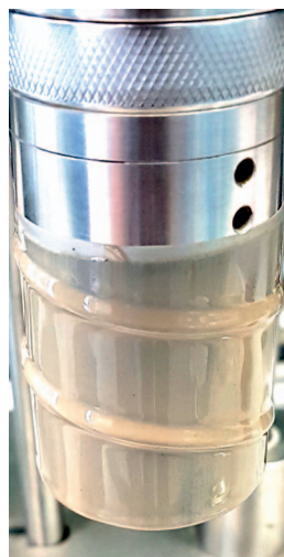
Fot. 4. Rotor z utworzonym osadem płuczkowym
