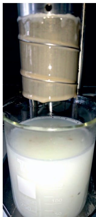
Fot. 6. Usunięcie osadu za pomocą cieczy przemysłowej na bazie środka RL8, stężenie 0,1%. Skuteczność usunięcia osadu równa 55,11%
