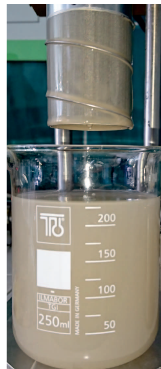
Fot. 8. Usunięcie osadu za pomocą cieczy przemywającej na bazie środka DC, stężenie 0,1%. Skuteczność usunięcia osadu równa 71,54%, wzrost efektywności usuwania 29% w porównaniu z wartością bazową
