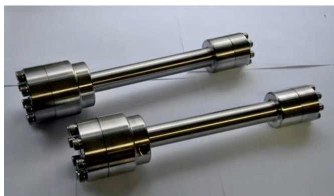
Fot. 1. Zdjęcie modułów membranowych w obudowie stalowej
