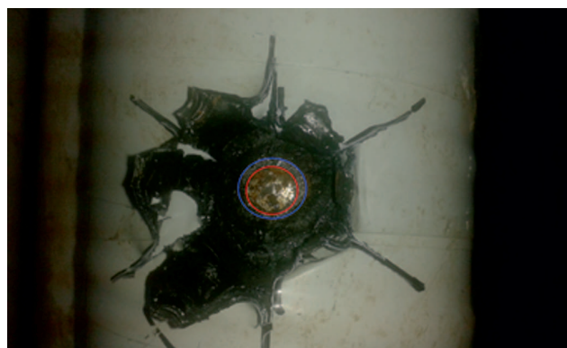
Fot. 2. Odspojenie powłoki wykonanej z taśm nawojowych wokół sztucznego defektu. Doskonale widoczny jest odspojony obszar wokół defektu powłoki
