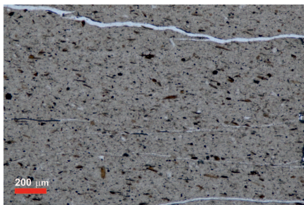
Rys. 3. Obraz mikroskopowy bentonitu: A – blaszki biotyту, widok w świetle przechodzącym, B – żyłki kwarcowe, widok w świetle spolaryzowanym
