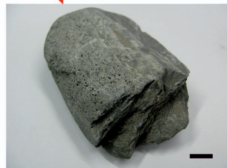
Rys. 2. Obraz makroskopowy bentonitu: A – pozycja próbek w rdzeniu (według dokumentacji otworowej rdzeni z otworu Borch-1, 2013), B – próbka pobrana do analizy. Skala na zdjęciu 1 cm
