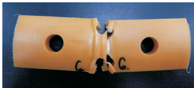
Fot. 3. Próbkę ze zgrzewu doczołowego nr 6 – warunki maksymalne – z rury dn 160 mm, SDR 11, PE 100 po badaniu odporności na rozciąganie zgrzewu doczołowego
