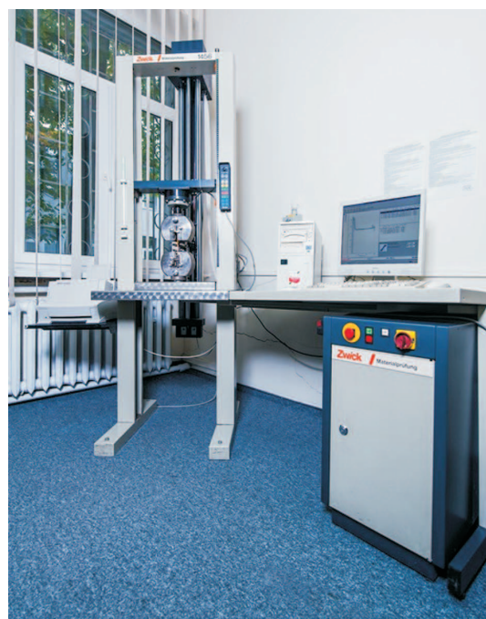
Fot. 2. Stanowisko do badania wytrzymałości na rozciąganie zgrzewu doczołowego
