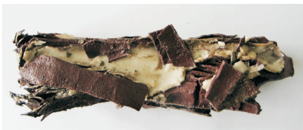
Fot. 8. Wygląd próbki C po 18 miesiącach działania środowiska korozyjnego
