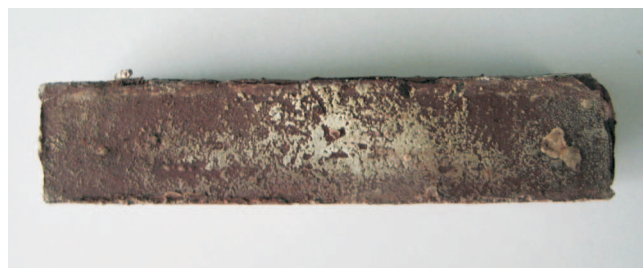
Fot. 9. Wygląd próbki D po 18 miesiącach działania środowiska korozyjnego
