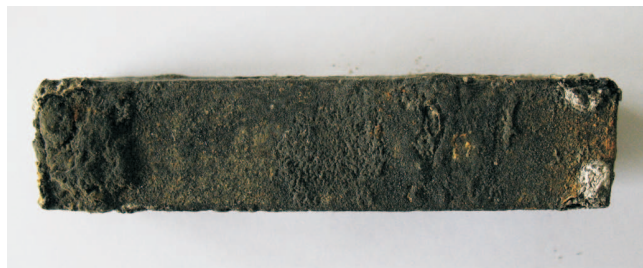
Fot. 7. Wygląd próbki B po 36 miesiącach działania środowiska korozyjnego
