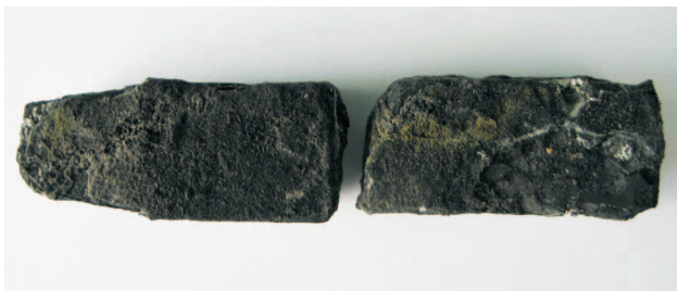
Fot. 6. Wygląd próbki A po 36 miesiącach działania środowiska korozyjnego
