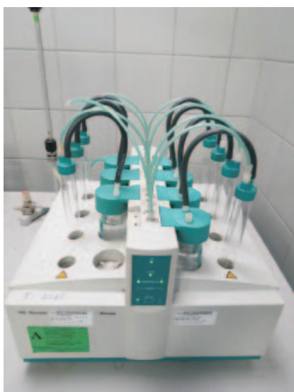
Fot. 1. Aparat do badań stabilności oksydacyjnej zgodnie z metodą PN-EN 15751 (fot. INiG – PIB)
