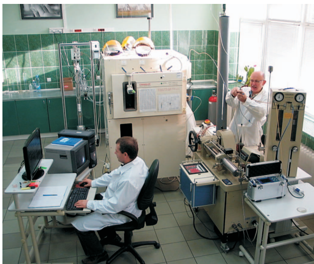
Rys. 4. Stanowisko badawcze do badań procesów wypierania – na drugim planie, z prawej strony, widoczny model złoża [5]
