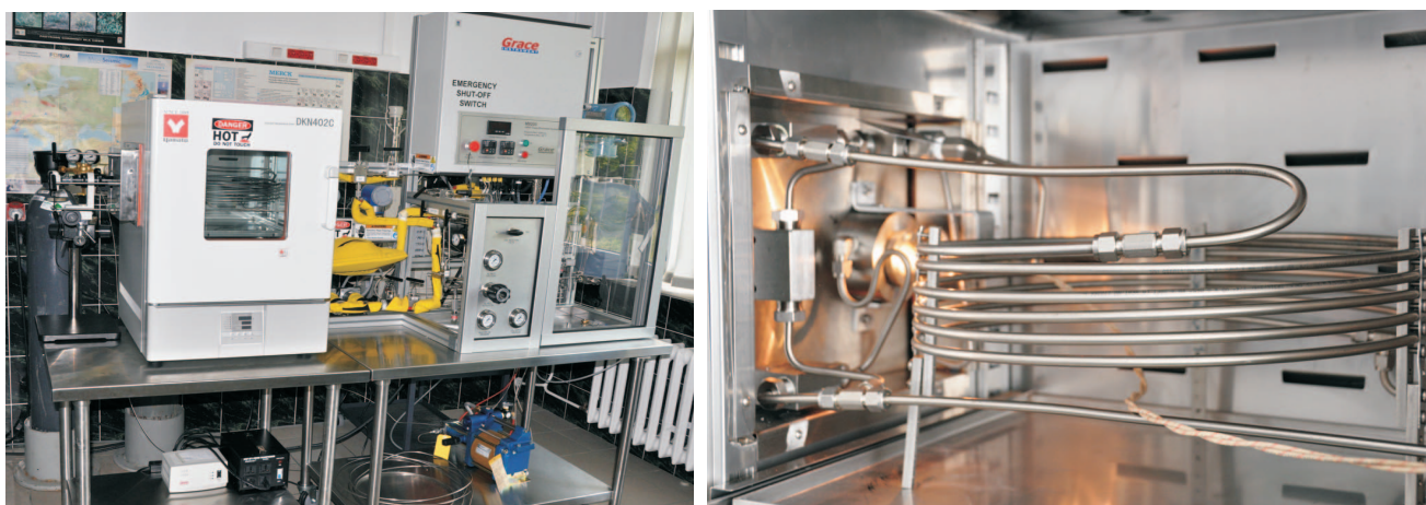
Rys. 4. Stanowisko do badań płynów szczelinujących z dodatkiem gazów N 2 /CO 2 oraz system pomiarowy umieszczony w komorze grzewczej
