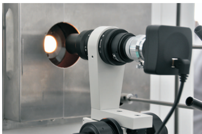
Rys. 6. Komora z kamerą do pomiaru spienionych cieczy
