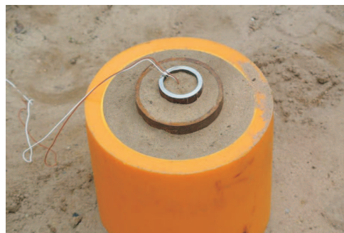
Rys. 4. Widok zestawu – części roboczej naczynia kumulacyjnego ŁKN-150-60-34/150 (w części roboczej ładunek ŁKL-16/80, 180 mm, około 15 g MW) – test poligonowy nr 1
