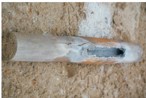
Rys. 5. Widok fragmentu rury wydobywczej 2 \frac{3}{8} cala po teście strzałowym nr 1
