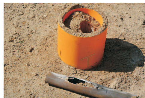
Rys. 6. Widok zestawu – części roboczej naczynia kumulacyjnego ŁKN-150-60-34/150 (w części roboczej ładunek ŁKL-16/80, 180 mm, około 15 g MW) – test poligonowy nr 2
