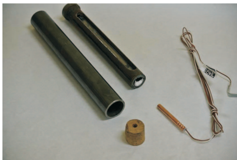
Rys. 4. Widok zestawu – części roboczej naczynia kumulacyjnego ŁKN-150-60-34/150 (w części roboczej ładunek ŁKL-16/80, 180 mm, około 15 g MW) – test poligonowy nr 1
