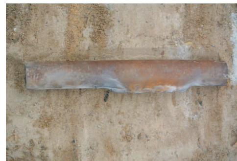
Rys. 5. Widok fragmentu rury wydobywczej 2 \frac{3}{8} cala po teście strzałowym nr 1
