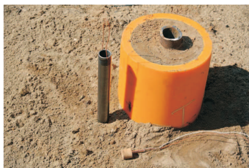
Rys. 6. Widok zestawu – części roboczej naczynia kumulacyjnego ŁKN-150-60-34/150 (w części roboczej ładunek ŁKL-16/80, 180 mm, około 15 g MW) – test poligonowy nr 2
