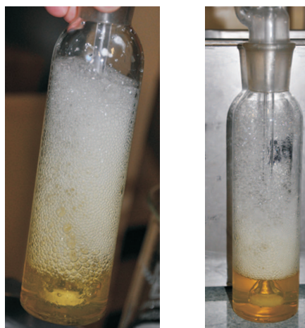
Rys. 3. Pienienie inhibitora korozji IK-1
