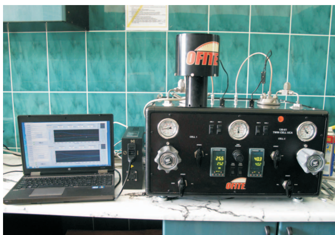
Fot. 2. Ultradźwiękowy analizator cementu z modulem SGSM
