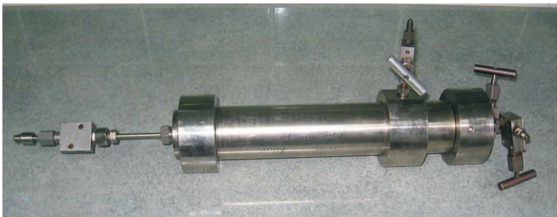
Rys. 2. Komora rdzeniowa – widoczny element wprowadzający płyny do baterii rdzeni [6]
