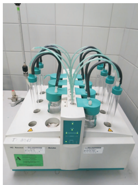
Fot. 3. Aparat do badań stabilności oksydacyjnej zgodnie z metodą PN EN 14112 oraz metodą PN EN 15751 (fot. INiG)
