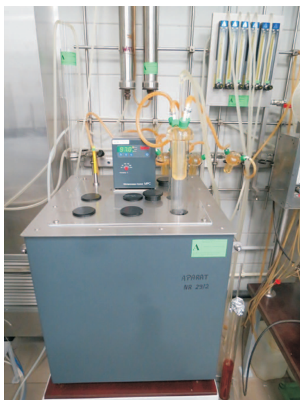
Fot. 1. Aparat do badań stabilności oksydacyjnej zgodnie z metodą PN ISO 12205 (fot. INiG)
