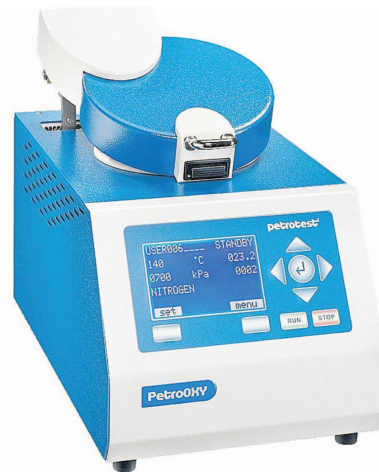
Fot. 4. Aparat do badań stabilności oksydacyjnej zgodnie z metodą EN 16091
