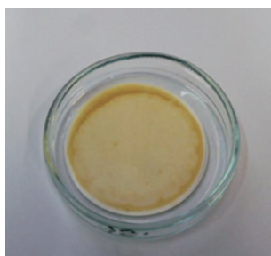
Fot. 2. Sączek i rura testowa po badaniu stabilności oksydacyjnej zgodnie z metodą PN ISO 12205 (fot. INiG)
