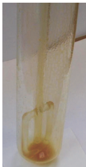
Fot. 2. Sączek i rura testowa po badaniu stabilności oksydacyjnej zgodnie z metodą PN ISO 12205 (fot. INiG)
