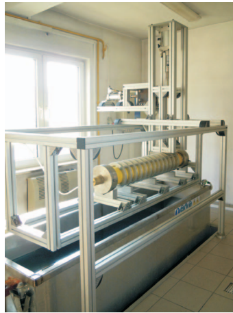
Rys. 3. Stanowisko do testu S4 w INiG w Krakowie
