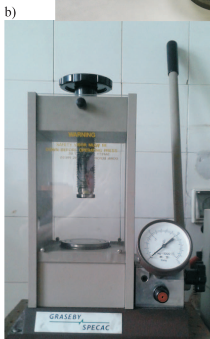
Rys. 3. Matryce do wykonania pastylek (a) i stosowana prasa hydrauliczna (b) (fot. TA)
