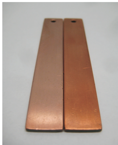
Rys. 6. Przykładowa płytka miedziana uzyskana w wyniku badania działania korodującego na miedź w porównaniu z płytką przed badaniem
