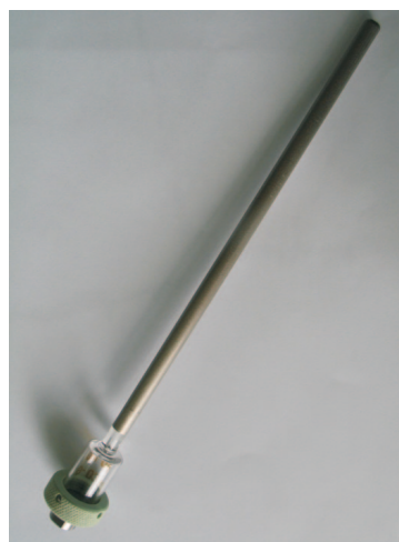
Fot. 2. Penetrometr, w którym umieszczana jest badana próbka
