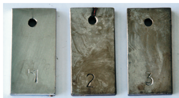
Fot. 2. Próbkki wykonane ze stali L-80 poddane testowi w środowisku cieczy nadpakerowej nr 3 z użyciem inhibitora korozji B6 w temperaturze 80°C
