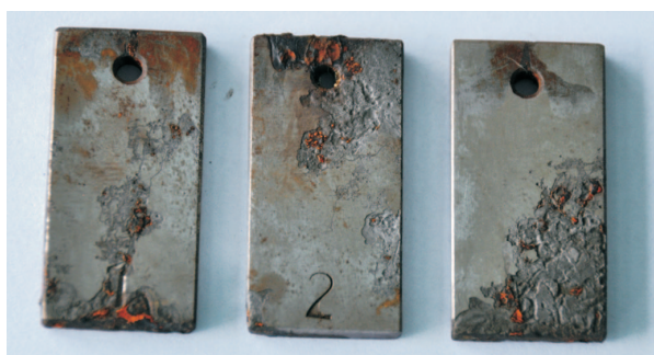
Fot. 1. Próbkki wykonane ze stali J-55 poddane testowi w środowisku cieczy nadpakerowej nr 1 z użyciem inhibitora korozji T8 w temperaturze 80°C
