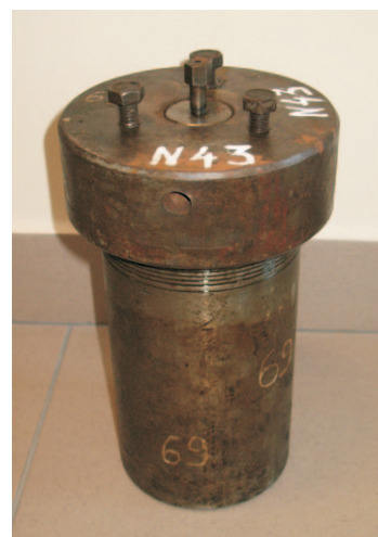
Fot. 3. Autoklaw do przechowywania próbek stwardniałych zaczynów cementowych
