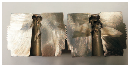
Rys. 5. Metalowe elementy wewnętrzne eksploatowanych zaworów
