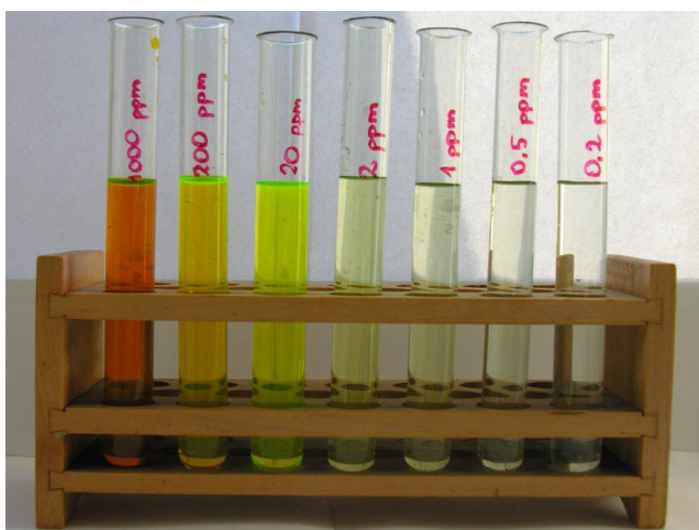
Fot. 2. Roztwory wzorcowe znacznika 1 na 7 poziomach stężeń: 1000 ppm, 200 ppm, 20 ppm, 2 ppm, 1 ppm, 0,5 ppm oraz 0,2 ppm
