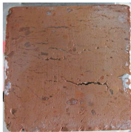
Fot. 6. Kostka po 3 minutach zmywania roztworem podchlorynu wapnia osadu wytworzonego przez ciecz nr 1
