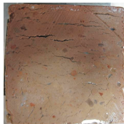
Fot. 8. Kostka po 5 minutach zmywania roztworem amylazy osadu wytworzonego przez ciecz nr 1
