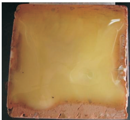
Fot. 5. Kostka z osadem wytworzonym przez ciecz nr 1 (przed zmywaniem)
