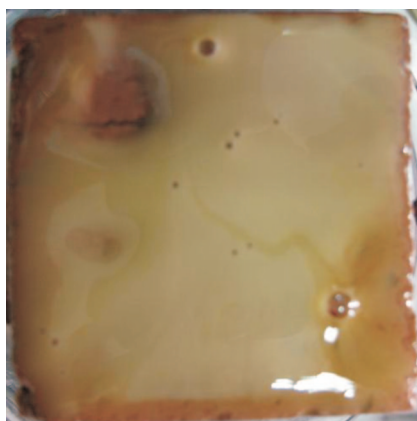
Fot. 7. Kostka z osadem wytworzonym przez ciecz nr 1 (przed zmywaniem)
