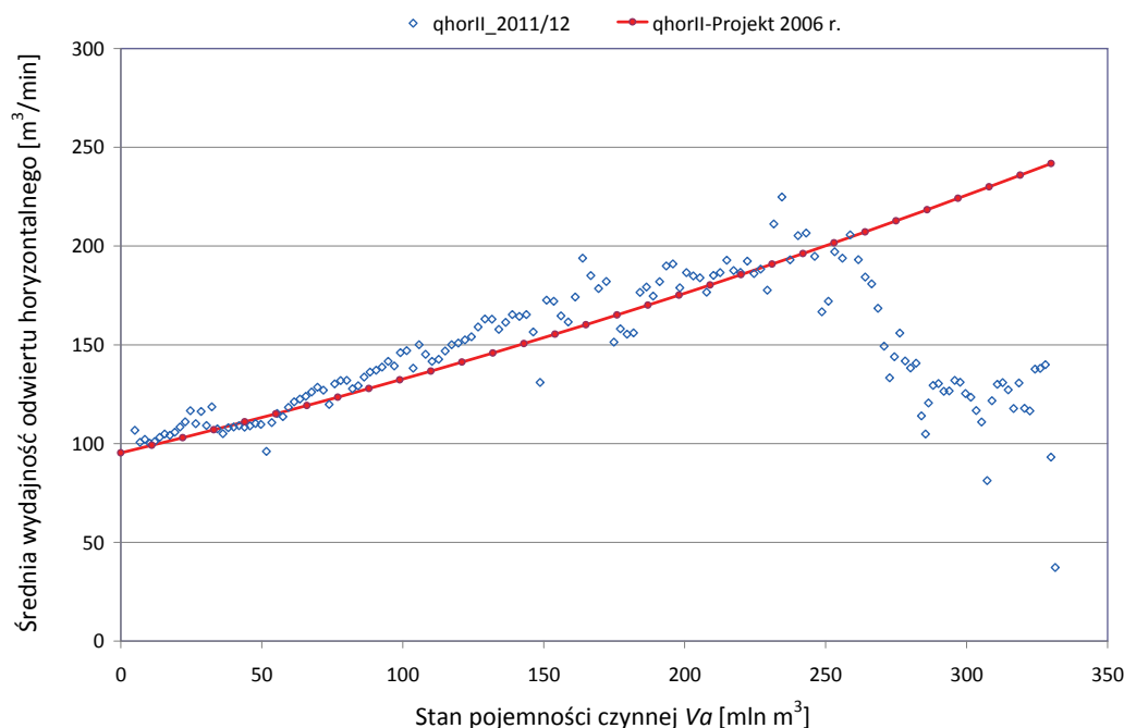
Rys. 5. PMG Strachocina. Wykres porównawczy projektowanej wydajności średniego odwiertu horyzontalnego z wydajnością rzeczywistą osiągniętą podczas fazy odbioru gazu w sezonie 2011/2012
