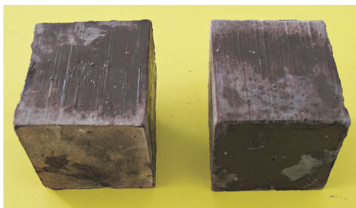
Fot. 1. Kostki o wymiarach 2 × 2 × 2 cale sporządzone z zaczynu cementowego nr 2, do badania wytrzymałości na ściskanie (czas hydratacji 7 dni)
