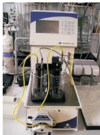
Fot. 2. Aparat do badań tendencji paliw do blokowania filtra paliwa FBT zgodnie z normą ASTM D 2068
