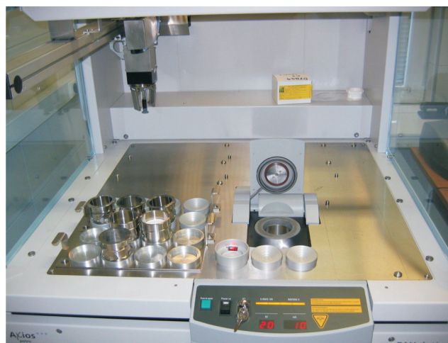
Rys. 2. Stanowisko do analizy próbek ciekłych i stałych, wraz z mechanizmem ich zmieniania, tacami i uchwytami
