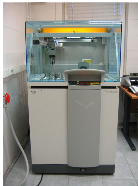
Rys. 1. Spektrometr rentgenowski Axios Petro
