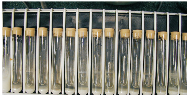
Rys. 1. Płuczka nr 2 po sześciu tygodniach. Widoczne całkowite zniszczenie struktury płuczki oraz różnice w lepkości pomiędzy poszczególnymi próbkami (front „płynięcia” zatrzymuje się w innym miejscu)
