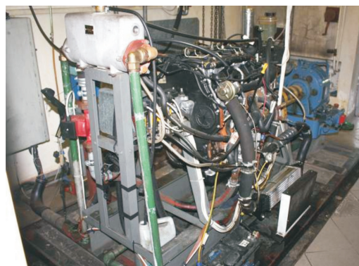
Rys. 2. Stanowisko badawcze z silnikiem FORD 2.0i 16V Duratorq TDCi
