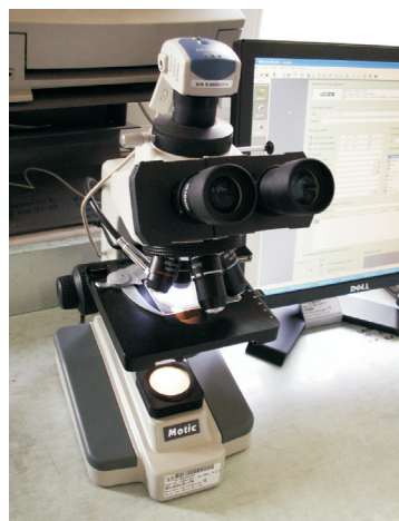
Fot. 1. Mikroskop optyczny wyposażony w kamerę do automatycznej analizy klasy czystości (fot. INiG Kraków)
