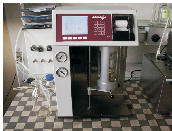
Fot. 2. Stacjonarny, automatyczny licznik cząstek do analizy klasy czystości (fot. INiG Kraków)
