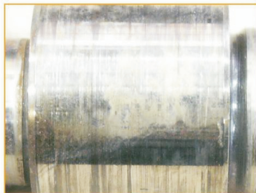
Fot. 5. Zużycie ścierno-adhezyjne wału napędowego pompy układu common rail silnika z zapłonem samoczynnym (fot. INiG Kraków)
