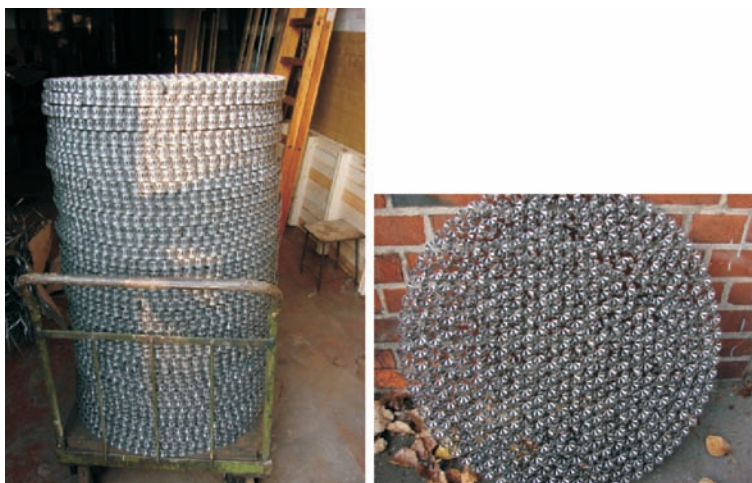
Rys. 1. Wypełnienie kolumny wykonane z pierścieni Białeckiego
