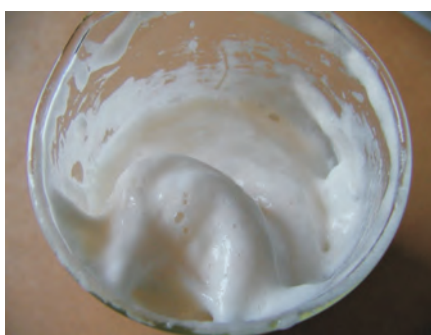
Fot. 5. Reakcja cieczy kwasującej, o składzie: 20% HCl + 0,3% inhibitor korozji + 5% wiskoelastyczny środek powierzchniowo-czynny E, z \text{CaCO}_3
