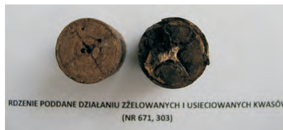
Fot. 4. Powierzchnie czołowe rdzeni po kwasowaniu żelowanym i usieciowanym kwasem HCl.
