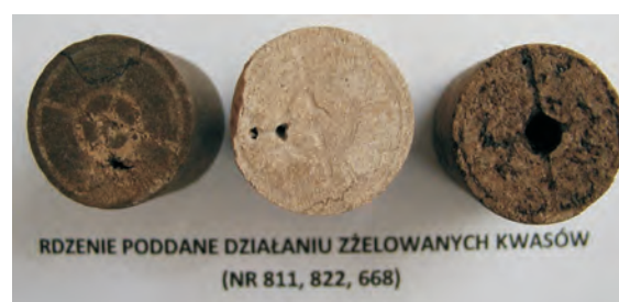
Fot. 1. Powierzchnie czołowe rdzeni po kwasowaniu żelowanym HCl
