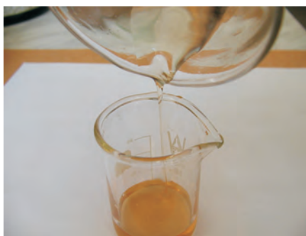
Fot. 6. Utworzony żel po reakcji z \text{CaCO}_3 (ekwiwalent 14% HCl)
