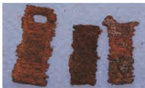
Fot. 2. Próbkki wykonane ze stali L-80 po teście w 15% HCl z dodatkiem inhibitora A 25
