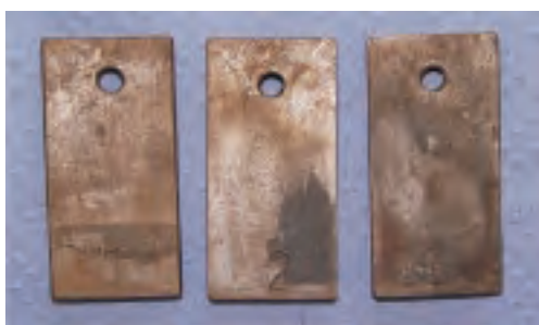
Fot. 1. Próbkki wykonane ze stali N-80 po teście w 15% HCl z dodatkiem inhibitora H 1
